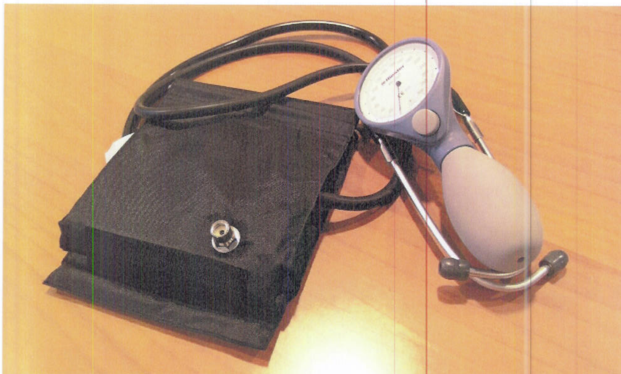
Slika 1: Izgled tlakomjera ri san s gumenom loptom za napuhavanje i manžetom za ruku
